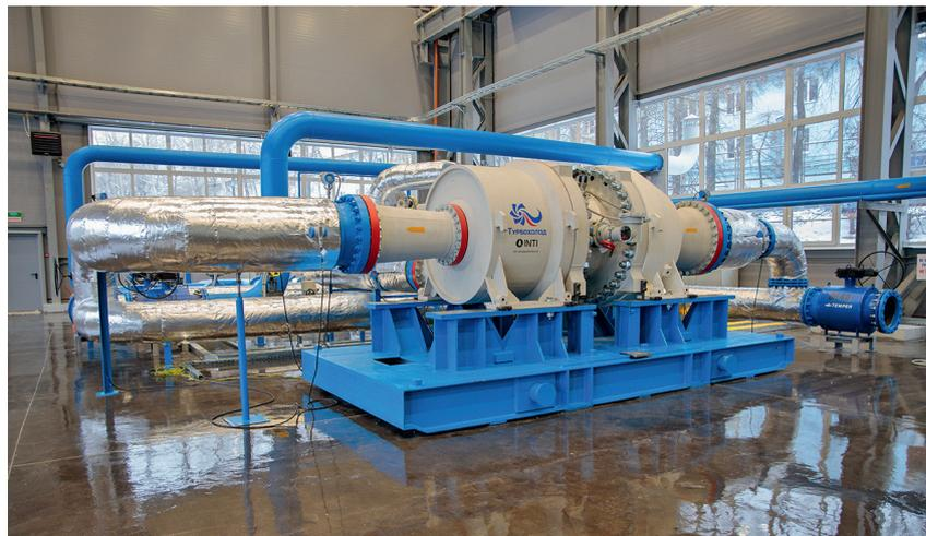
**ОСОБЕННОСТЬЮ РАЗРАБОТАННОЙ КОНСТРУКЦИИ АДКГ-40 ЯВЛЯЕТСЯ ВНУТРЕННИЙ АВТОНОМНЫЙ МОДУЛЬ, ВКЛЮЧАЮЩИЙ В СЕБЯ ВАЛ, СТАТОРНЫЕ И РОТОРНЫЕ ЧАСТИ СИСТЕМЫ АМП, КОЛЕСА ТУРБИНЫ И КОМПРЕССОРА, ПОЗВОЛЯЮЩИЙ ПРОВОДИТЬ ИСПЫТАНИЯ АМП БЕЗ УСТАНОВКИ РОТОРА В КОРПУС АГРЕГАТА.**
